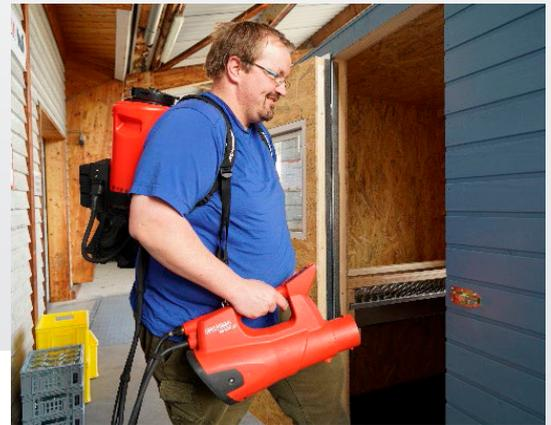
Traditionell wird Kieselgur in Pulverform ausgebracht (biologische Bekämpfung der roten Vogelmilbe). Durch Auflösung des Pulvers im Wasser und mittels Einsatzes der AS 1200 hat sich der Pulververbrauch um rund 25% reduziert. Die AS 1200 ermöglicht zudem eine gleichmässigeren Ausbringung und eine stärkere Verdünnung des Pulvers im Wasser (im Vergleich zur Ausbringung nur mittels REC 15).
