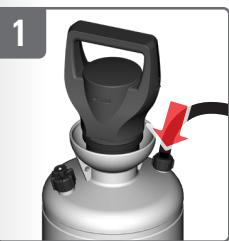
Schlauch an Druckbehälter schrauben
